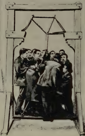
900 kg supportés par le cadre, charge représentée par 12 hommes.
