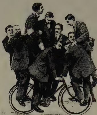
675 kg supportés par la bicyclette, charge représentée par 9 hommes.
