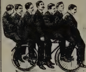
525 kg supportés par la bicyclette, charge représentée par 7 hommes.
