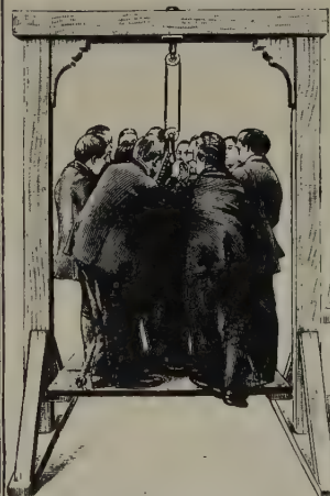
1.200 kg supportés par la chaîne, charge représentée par 14 hommes.
